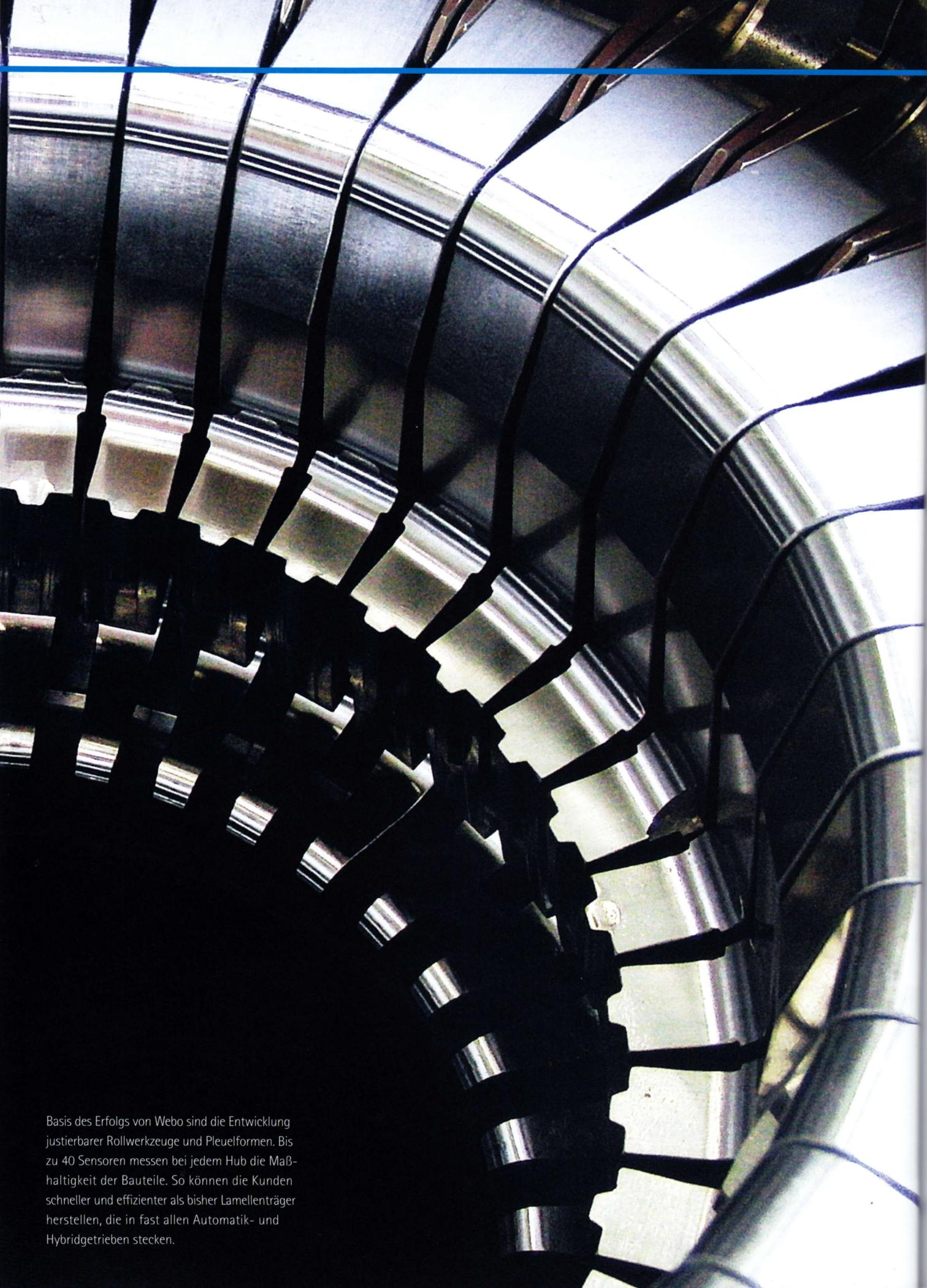
Basis des Erfolgs von Webo sind die Entwicklung justierbarer Rollwerkzeuge und Pleueformen. Bis zu 40 Sensoren messen bei jedem Hub die Maßhaltigkeit der Bauteile. So können die Kunden schneller und effizienter als bisher Lamellenträger herstellen, die in fast allen Automatik- und Hybridgetrieben stecken.
