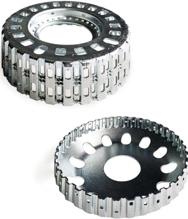
Moderne Doppelkupplungsgetriebe benötigen mehr Lamellen als herkömmliche Schaltgetriebe und müssen daher mit deutlich größerer Bauteiltiefe gefertigt werden. Diese Getriebe arbeiten zudem mit höheren Drehzahlen und stellen so extreme Anforderungen an die Präzision der Lamellenträger.
