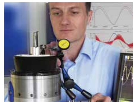
Bernd Essig, Leiter Entwicklung Mechatronische Systeme bei MAPAL, vermisst die Spezifikationen des Aussteuerwerkzeugs.
