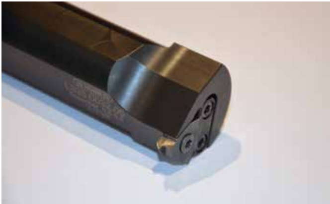
Die Schneidengeometrie und die Beschichtung des Systems von Horn sind für die prozesssichere Bearbeitung von Inconel 718 entscheidende Faktoren.
