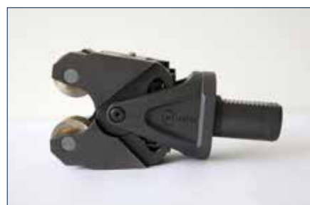
Der Halter eines Tangential-Gewinderollkopfs kommt aus dem 3D-Drucker.
