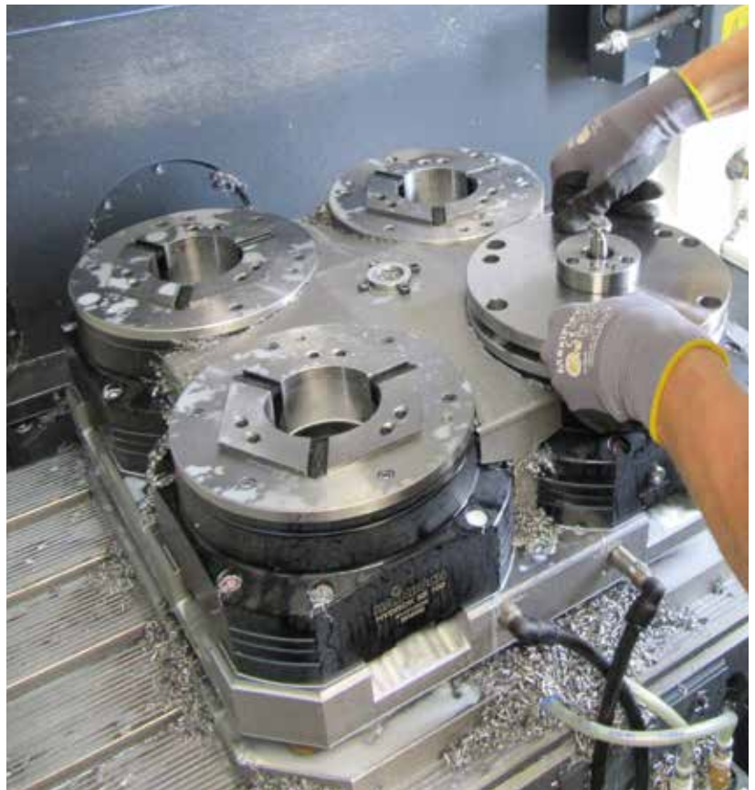
In den hydraulischen Spannstöcken ist kein Platz mehr für einen Span. Der Wechsel von Außen- auf Innenspannung geht schnell vonstatten.
