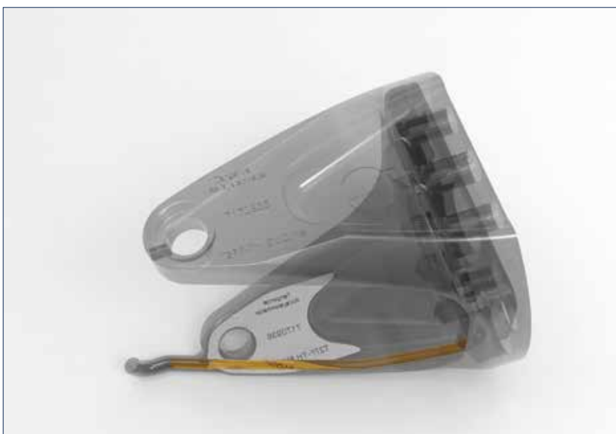
Der Halter eines Tangential-Gewinderollkopfs kommt aus dem 3D-Drucker.
