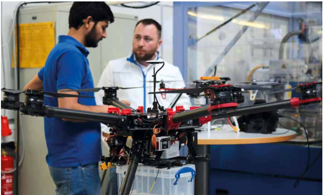
Die Greiferbacken der Drohne sind mit Hilfe des 3D-Drucks entwickelt worden. Dadurch lassen sich auch Greifer für komplexe Formen schnell realisieren.
