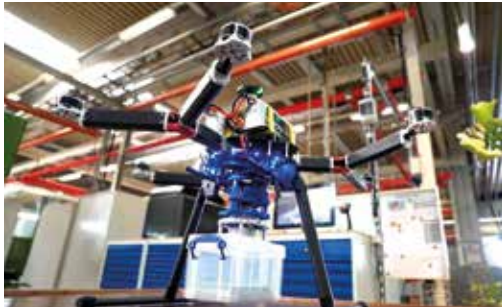
Der Drohnengreifer ermöglicht die direkte Belieferung. Damit wird künftig in der innerbetrieblichen Logistik ein besonders schneller Nachschub möglich.
