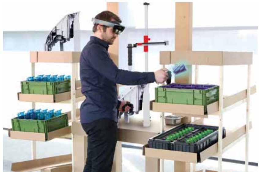
Ein Montagesystem für Scheinwerfer gleicht die Nachteile von Papp-Prototypen durch den Einsatz von Augmented Reality aus. Bauteile werden durch digitale Abbilder ergänzt.
