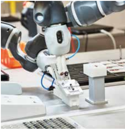
Der Zweiarmroboter bietet höchste Flexibilität. Bei gleichbleibenden Aufgaben wie dem Aufnehmen einer Ablage oder der Platzierung eines Chips hilft er bei Erhöhung der Produktionsgeschwindigkeit und Steigerung der Qualität.
