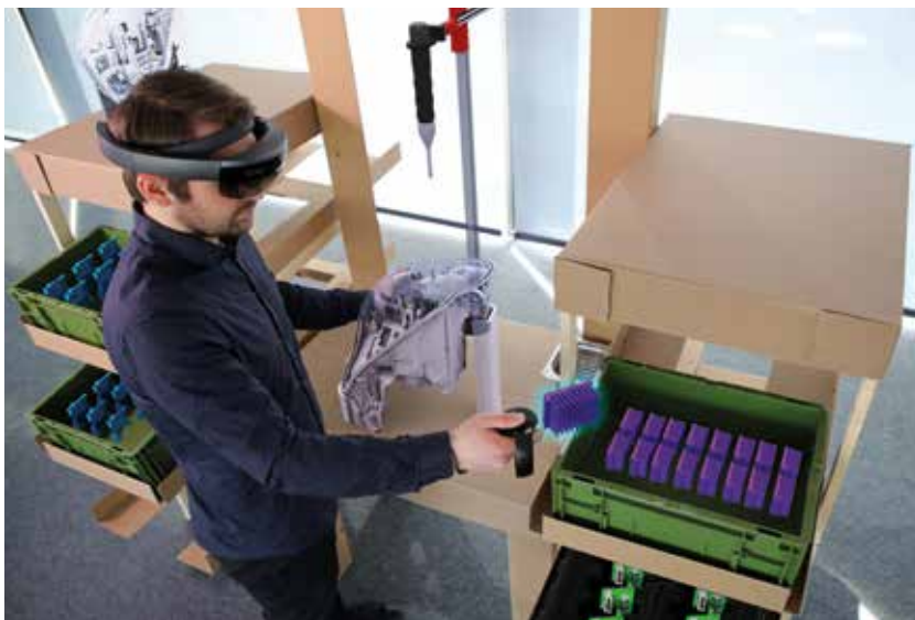
Ein Papp-Prototyp wird digitalisiert: Künftige Scheinwerfer-Bauteile werden via Augmented Reality angezeigt. Sie ermöglichen die optimale Arbeitsplatzplanung.
