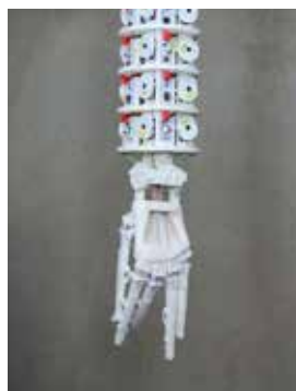
Fast alle Teile von Roboy werden additiv mithilfe des Lasersinterverfahrens gefertigt.
