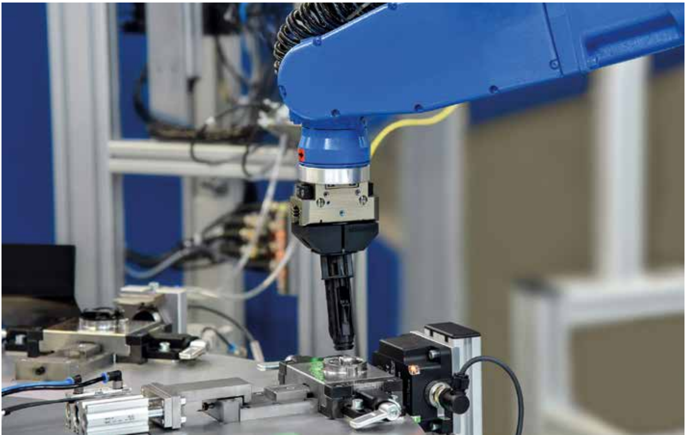
Reise auf dem Rundschalttisch: Der Roboter legt die Führungshülse ein.
