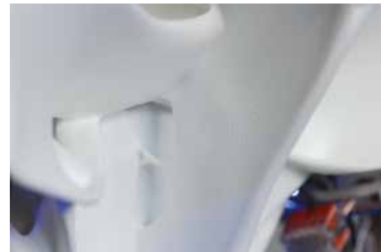
Additiv gefertigt: Die Hüfte von Roboy 2.0 ist durch den Einsatz von Autodesk Fusion 360 wesentlich leichter.
