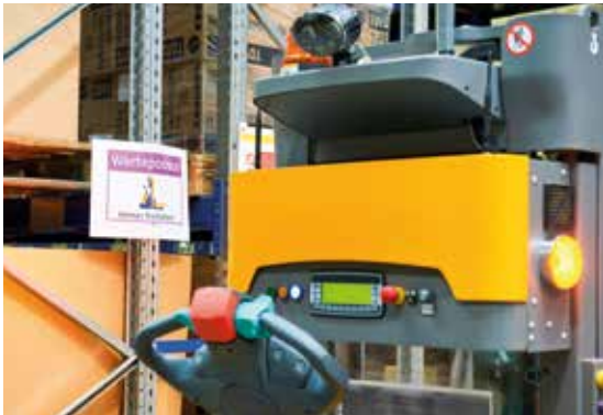
Wird ein Fahrzeug aktuell nicht benötigt, begibt es sich automatisch auf die nächste Warteposition bis es wieder von einem Kommissionierer angefordert wird.
