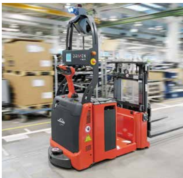
Autonom unterwegs: Ein Routenzug stellt die Ware bereit und sorgt für eine höhere Produktivität nach dem Kanban-System.
