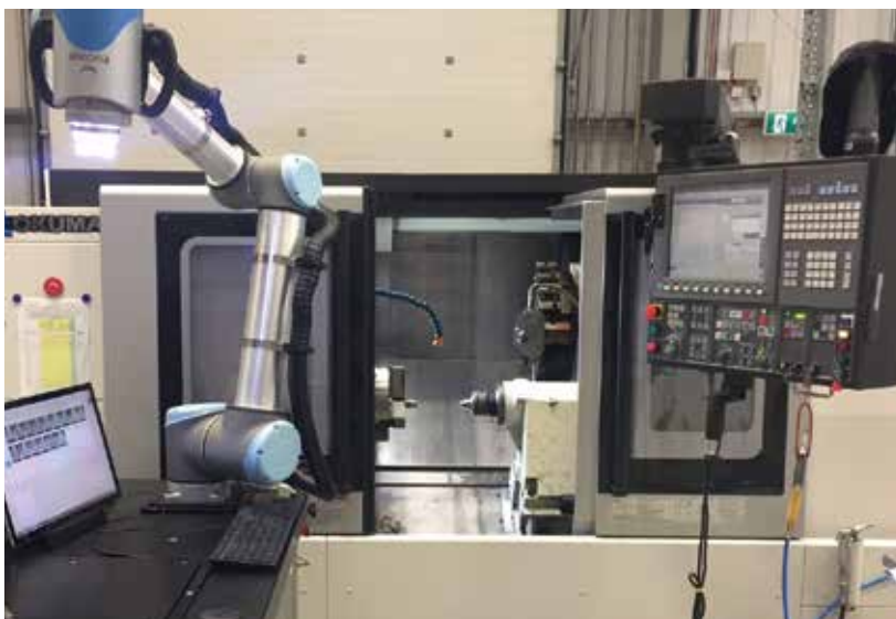
Mit dem Cobot werden sowohl das Werkzeug als auch das Werkstück direkt in der Drehmaschine gemessen. Der Ablauf erfolgt mittels einer zentralen Steuerung vollautomatisch.
