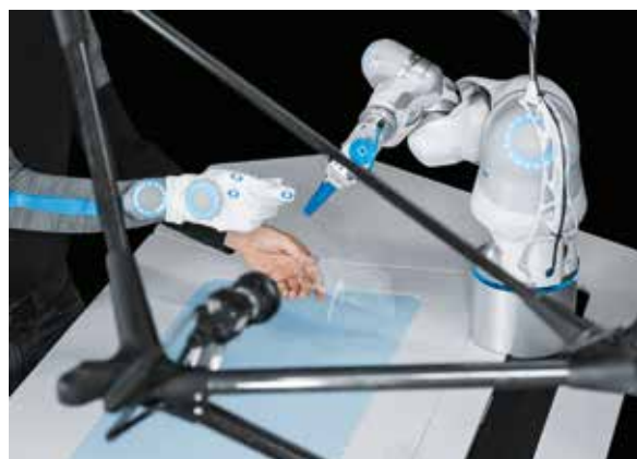
Sensoren und Kamerasysteme erfassen die Positionen von Werker, Bauteilen und Werkzeugen.
