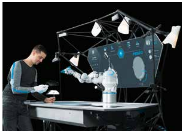
Im Bionic Workplace arbeitet der Mensch mit einem Roboterarm sowie zahlreichen Assistenzsystemen zusammen, die miteinander vernetzt sind.
