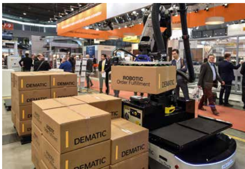
Kombiniert mit Robotertechnik können fahrerlose Transportsysteme auch über den Transport hinaus eingesetzt werden und beispielsweise die Kommissionierung übernehmen.
